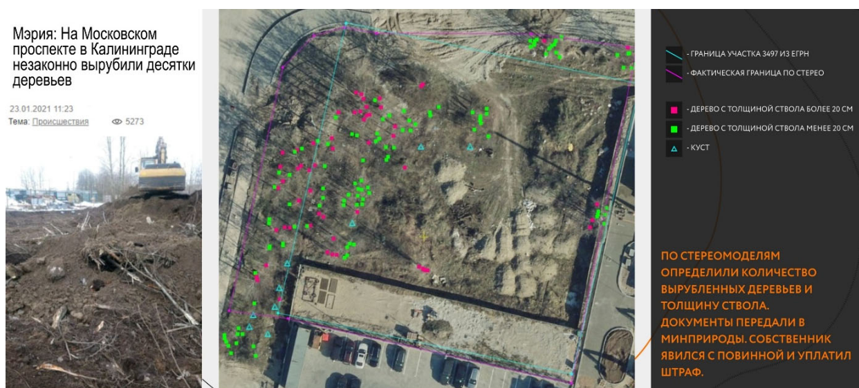
Рис. 7. Пример определения объема незаконной вырубки
