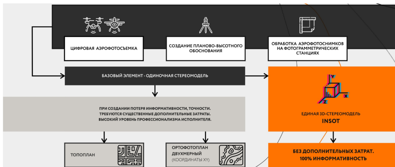
Рис. 1. Технологическая схема создания стереомодели территории
