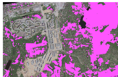
Рис. 3. Изображение фрагмента снимка 06-2010 с результатами автоматического распознавания леса, гидрографии
