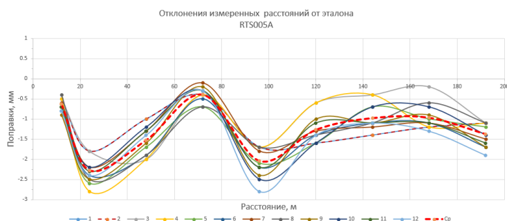
Рис. 3. Графики отклонения измеренных длин от эталона (красной пунктирной линии обозначено среднее отклонение)
