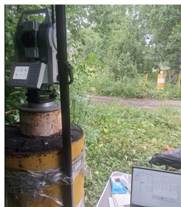
а) установка тахеометра
