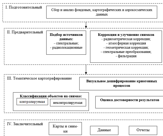
Рис. 2. Технологическая схема обработки материалов космической съемки при картографировании криогенных процессов
