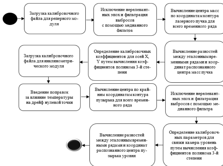
Рис. 2. Uml-диаграмма действий для калибровки датчика перемещений (ДВП)
