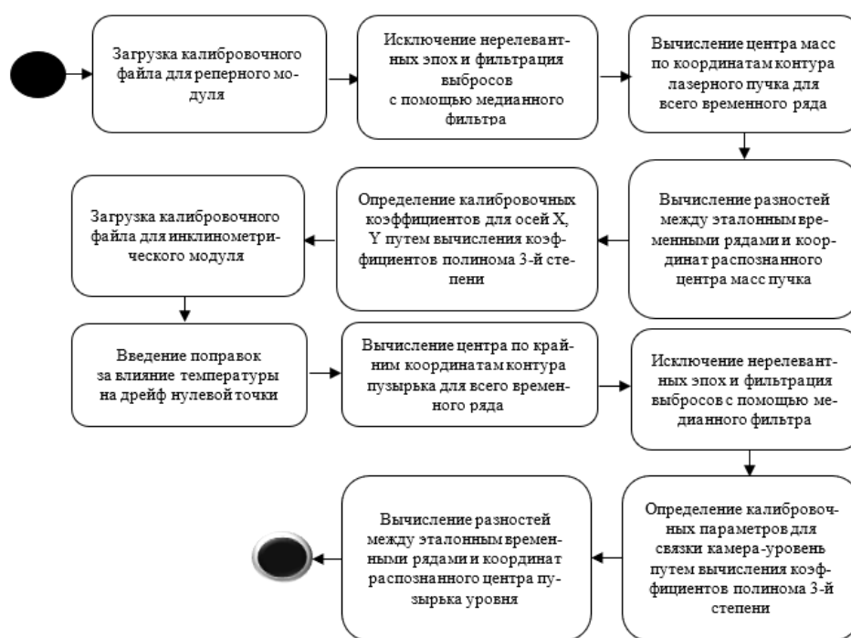
Рис. 2. Uml-диаграмма действий для калибровки датчика перемещений (ДВП)
