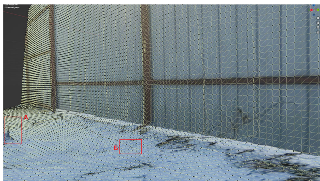
Рис. 1. Дефекты трехмерной модели, полученной с помощью лазерного сканирования: А – искажение геометрии; Б – нарушение топологии
