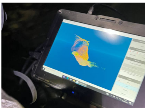
Рис. 2. Результаты сканирования в Heron в режиме реального времени
