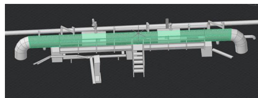
Рис. 4. Трехмерная цифровая модель КПП СОД в программном обеспечении nanoCAD с уровнем детализации LOD 400
