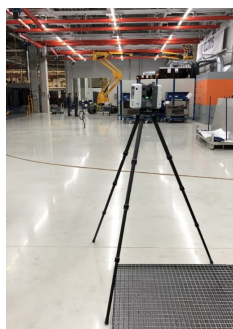
Рис. 1. Наземный лазерный сканер Leica RTC360
