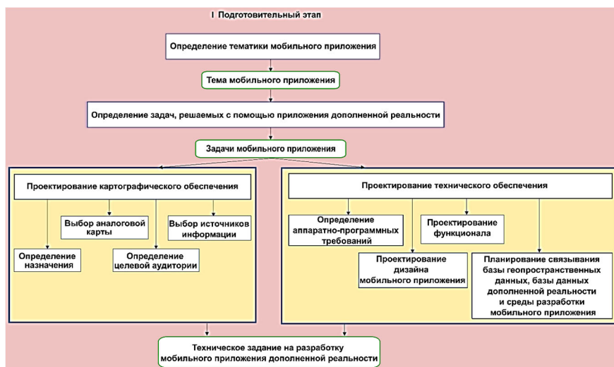
Рис. 2. Подготовительный этап создания мобильного приложения дополненной реальности для аналоговых карт
