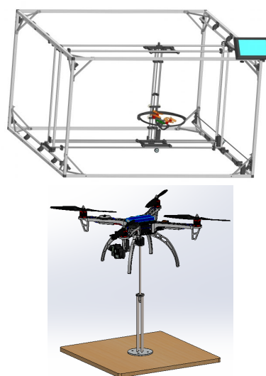
Рис. 2. Конструктивные способы обеспечения возможности перемещения квадрокоптера в пространстве
