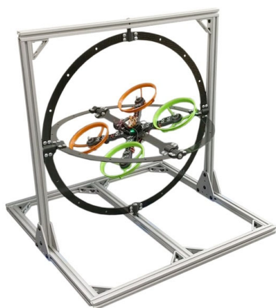
Рис. 1. Использование карданова подвеса на стенде для обеспечения возможности вращения квадрокоптера в произвольном направлении
