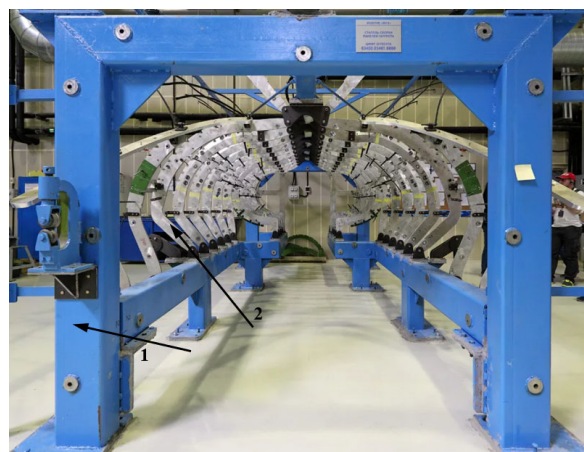
Рис. 1. Стапель для сборки панели самолета: 1 – несущая рама; 2 – ложементы
