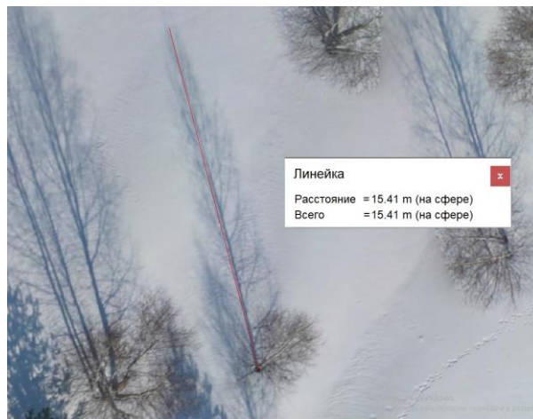
Рис. 6. Определение высоты дерева по длине его тени
