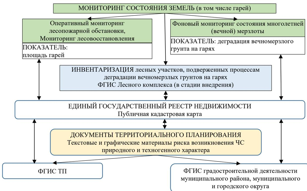
Рис. 5. Технологическая схема информационного обеспечения планирования использования территорий вечномерзлых грунтов для прогнозирования риска возникновения чрезвычайных ситуаций природного характера
