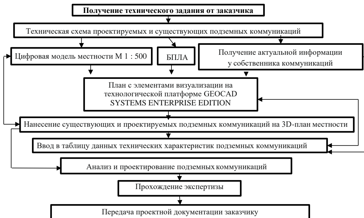
Рис. 1. Блок-схема проектирования инженерных коммуникаций с элементами визуализации
