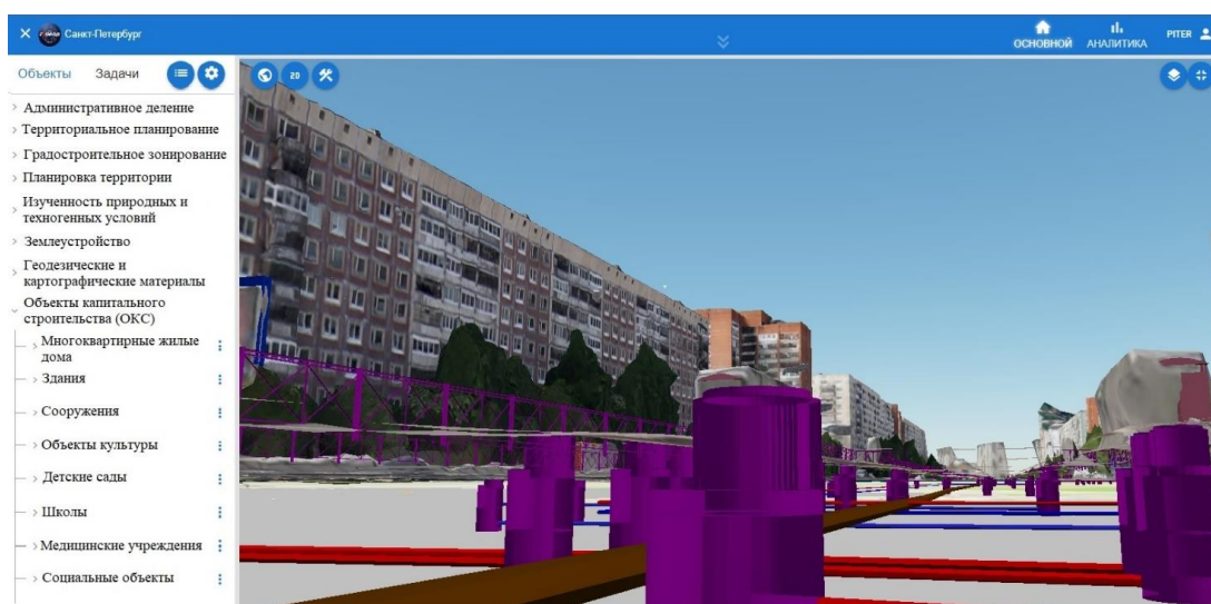
Рис. 5. 3D-модель подземных коммуникаций
