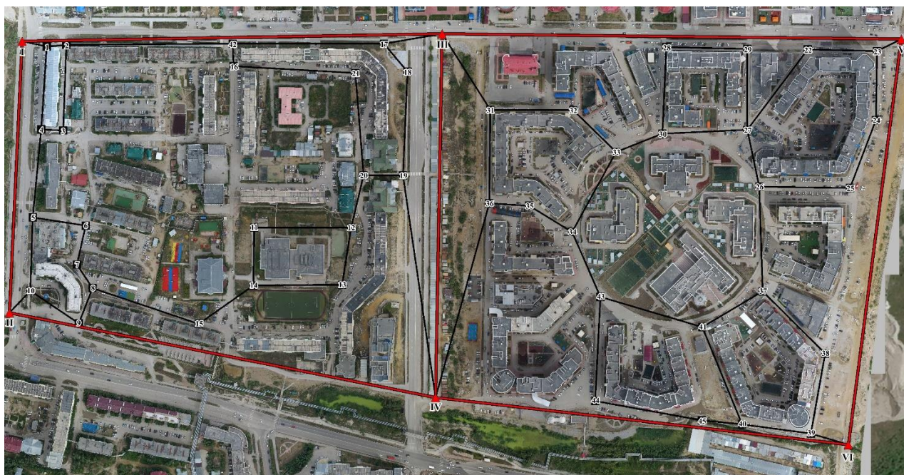
Рис. 2. Проект второй ступени геодезической сети специального назначения
