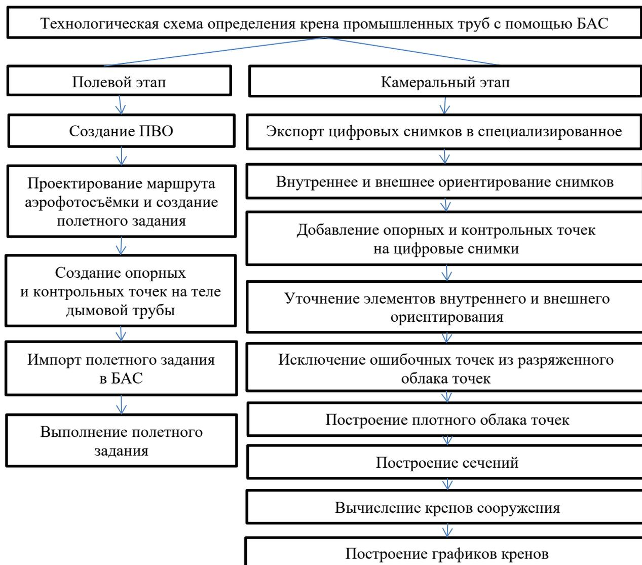
Рис. 1. Технологическая схема определения крена промышленных труб с помощью БАС
