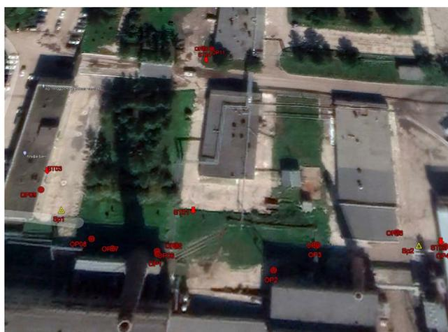
Рис. 2. Схема плано-высотного обоснования на территории промплощадки
