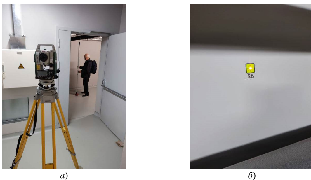
Рис. 5. Передача высоты тригонометрическим нивелированием с временного репера на деформационную марку, закрепленную пленочным отражателем:
