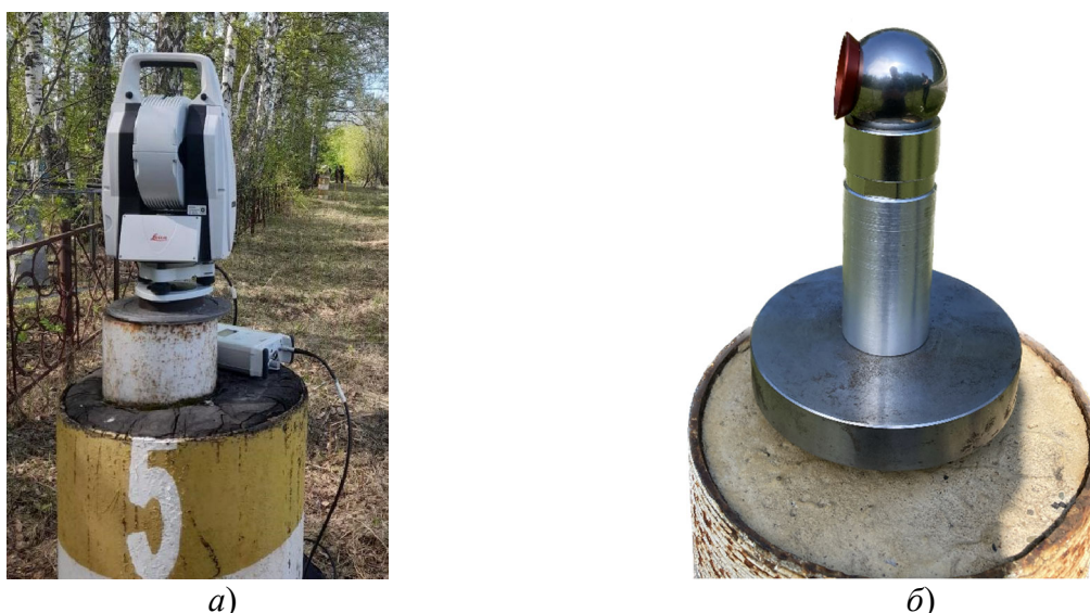
Рис. 2. Измерение базиса лазерным трекером Leica AT 403:
