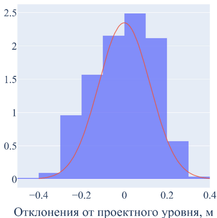
Рис. 1. Гистограмма распределения погрешности позиционирования отвала бульдозера по высоте
