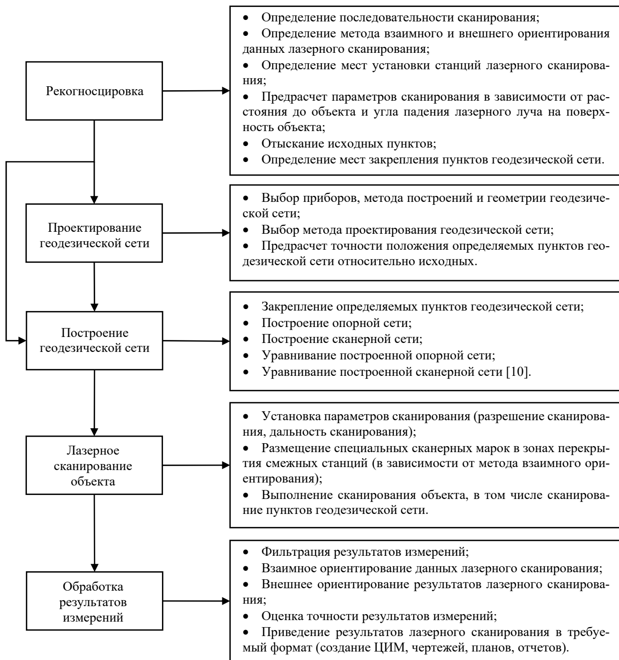
Рис. 1. Обобщенная технологическая схема наземного лазерного сканирования промышленных объектов
