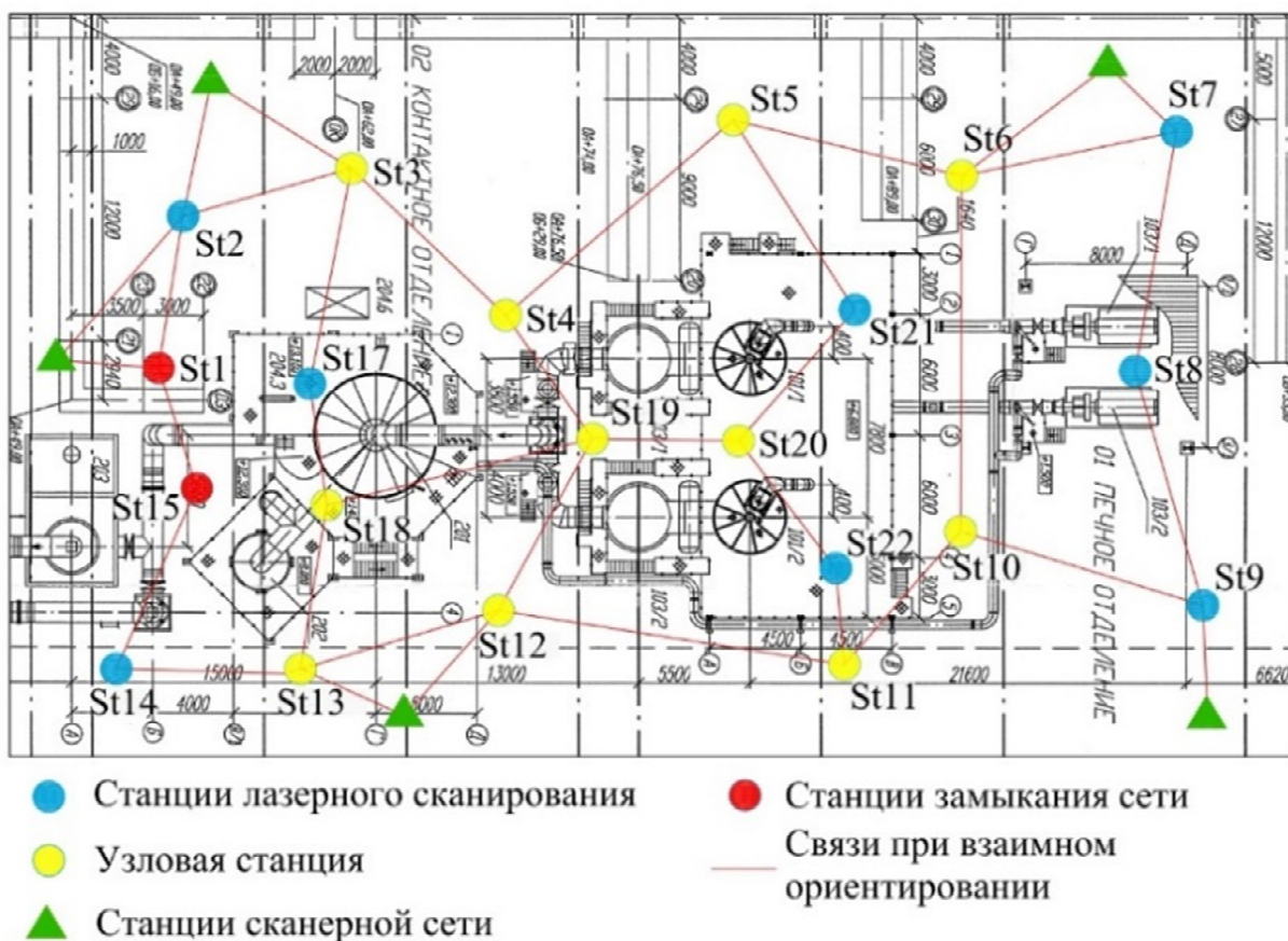
Рис. 5. Схема расположения станций лазерного сканирования при выполнении измерений технологического блока
