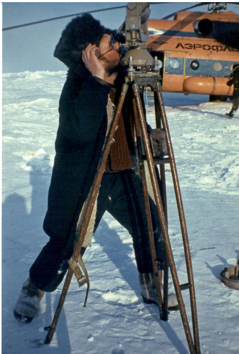
Рис. 5. Астрономические наблюдения методом Сомнера – Акимова. Наблюдатель – В. А. Ащеулов
