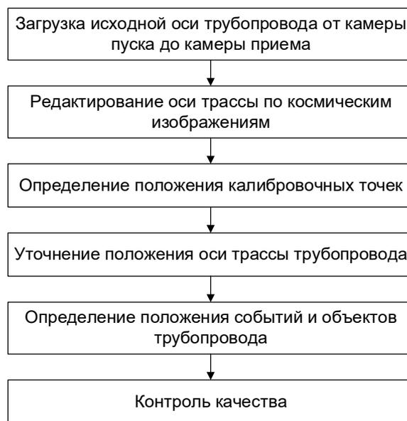
Рис. 2. Методика геопространственного моделирования трубопроводов в ArcGIS Pro с использованием модуля ArcGIS Pipeline Referencing
