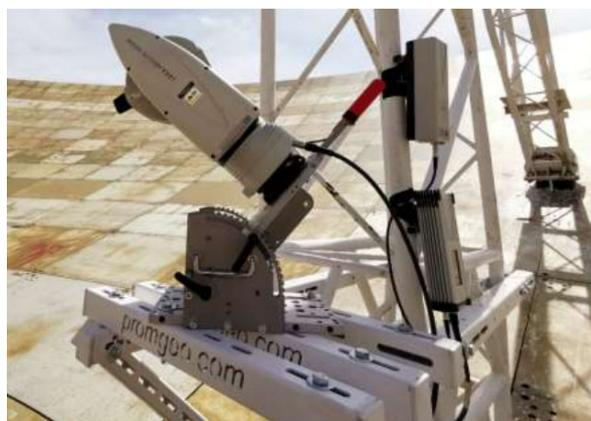
Рис. 5. Установка лазерного трекера Leica ATS600
