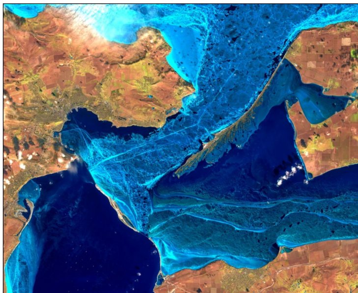
Рис. 6. Опоры мостового перехода через Керченский пролив и дамба на косе Тузла остановили движение полей льда со стороны Азовского моря (космический снимок Sentinel-2 от 13.02.2017 [15])
