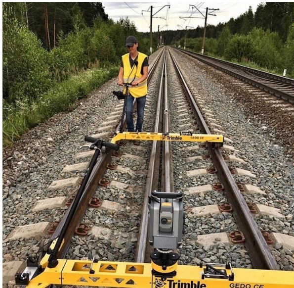
Рис. 2. Путеизмерительная система Gedo
