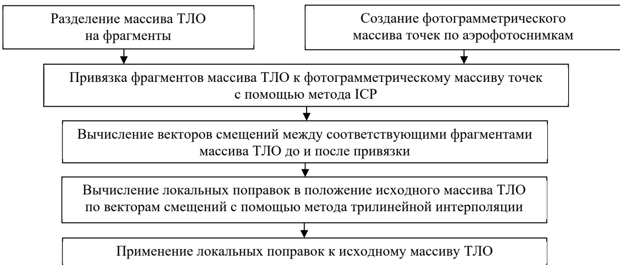
Рис. 2. Схема привязки данных МЛС к результатам аэрофотосъемки на основе трехмерного подхода
