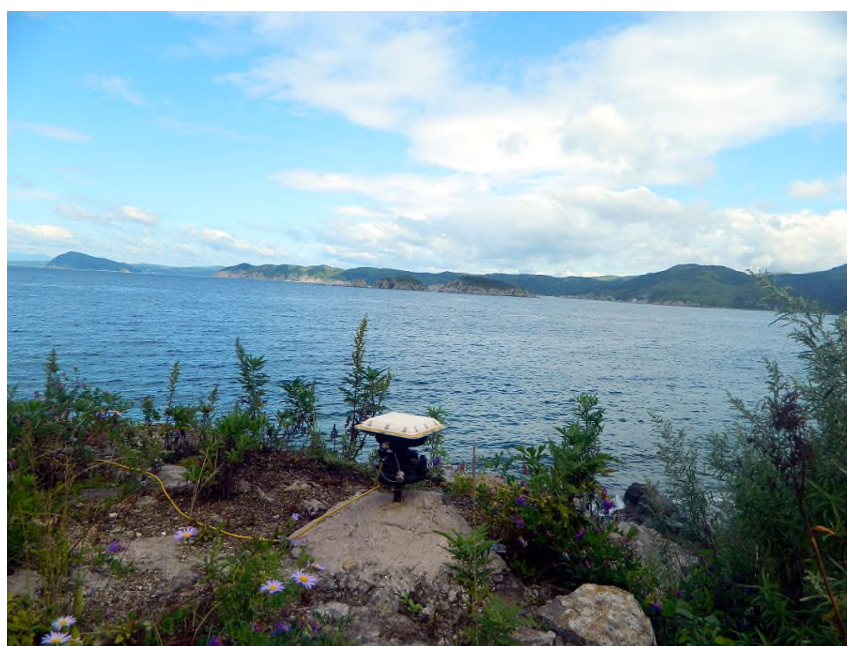
Рис. 5. Положение антенны приемника ГНСС на геодезическом репере при измерениях на гравиметрическом пункте № 2 (см. рис. 3, б)
