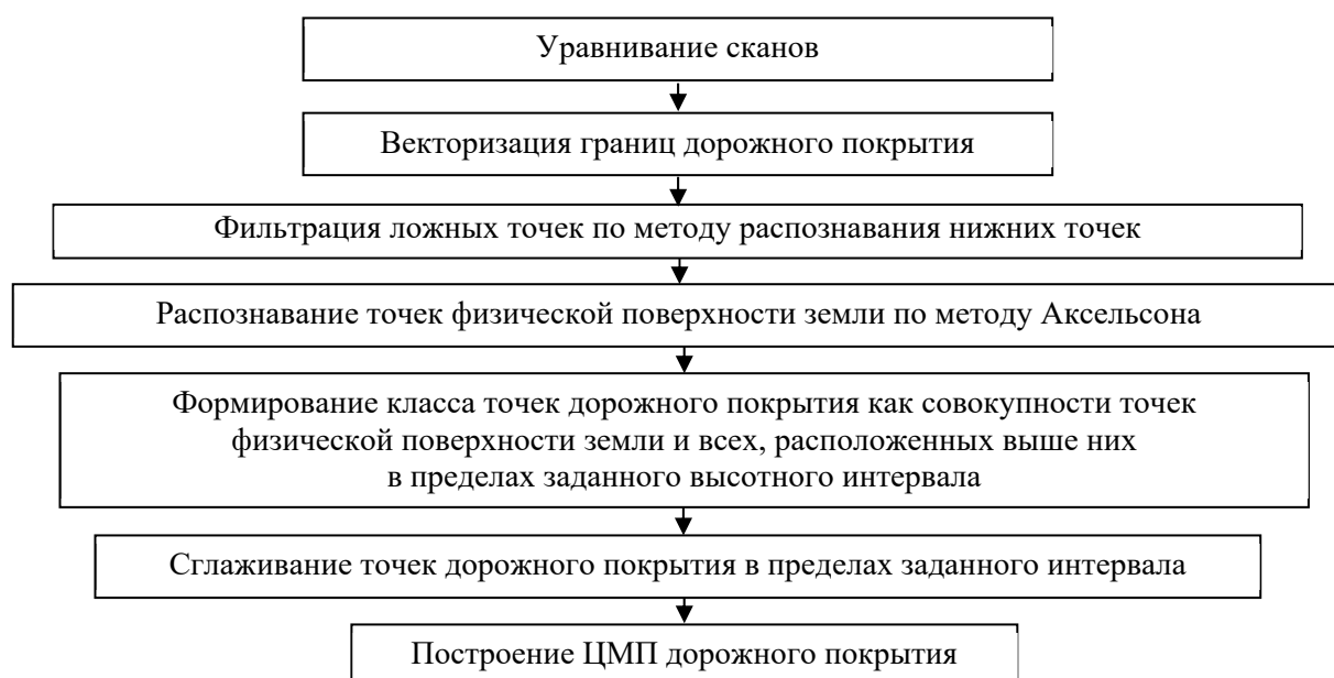
Рис. 4. Методика обработки данных НЛС для построения ЦМП дорожного полотна
