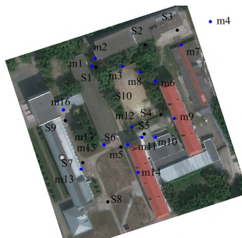
Рис. 2. Схема создания ПВО для ScanStation 2: ● – марки m1–m17; ● – сканерные позиции S1–S10
