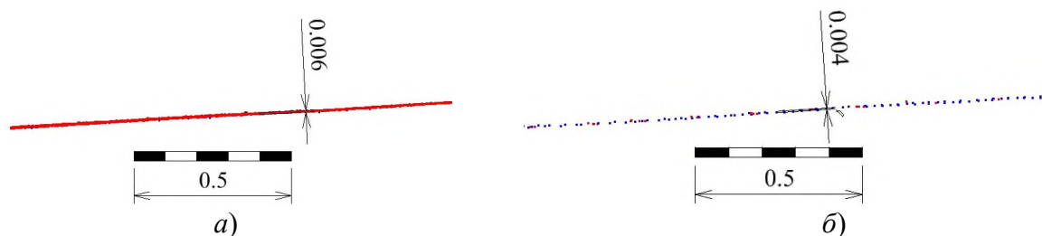
Рис. 6. Сечения по массиву ТЛЮ ScanStation 2 после дорожных работ: а) № 1; б) № 2
