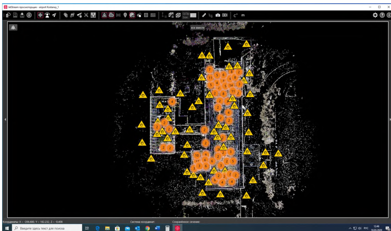
Рис. 4. Расположение станций сканирования при съемке аэровокзала
