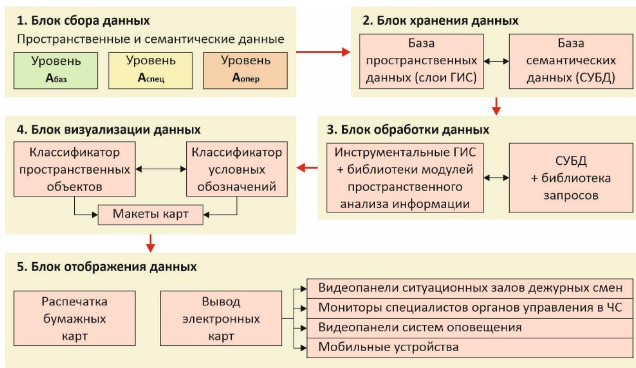
Рис. 6. Обобщенная функциональная схема предложенной ЦСКО
