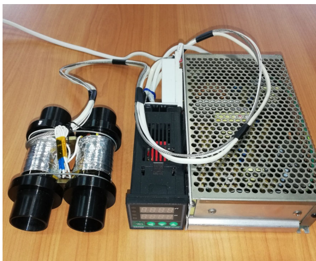
Рис. 2. Стенд для исследования спектров поглощения адсорбированных слоев
