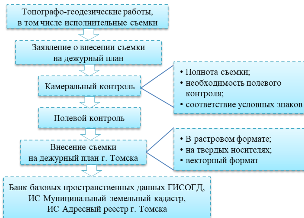
Рис. 7. Порядок актуализации дежурного топографического плана г. Томска
