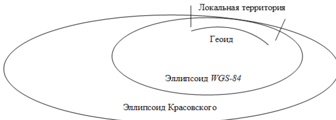
Рис. 2. Принципиальная схема для определения согласующих параметров Гельмерта для локальных территорий без привлечения информации о модели высот квазигеоида при совмещении поверхностей эллипсоидов в точке
