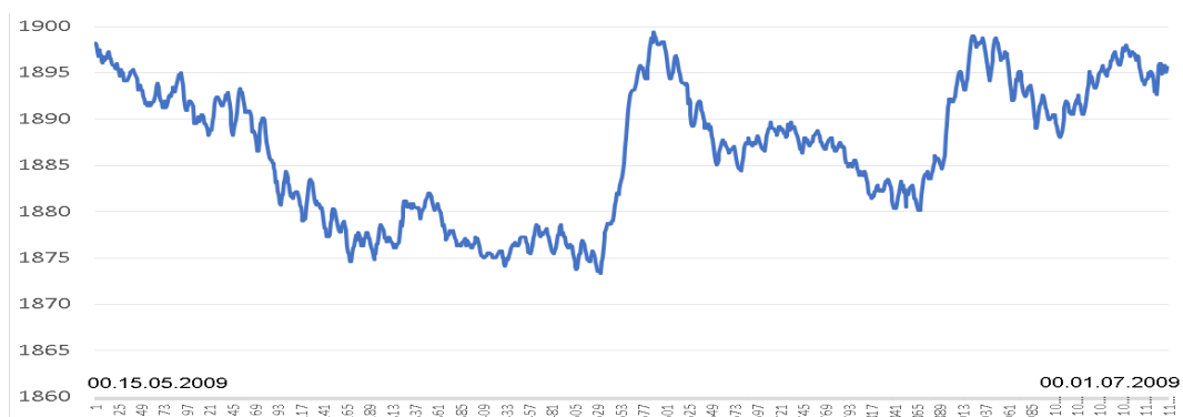
Рис. 6. Пример приливных вариации водного уровня, почасовые данные, зарегистрированные с 15 мая по 1 июля 2009 гг. в скважине Талая. Вертикальная шкала в миллиметрах. Приливная амплитуда 2 мм
