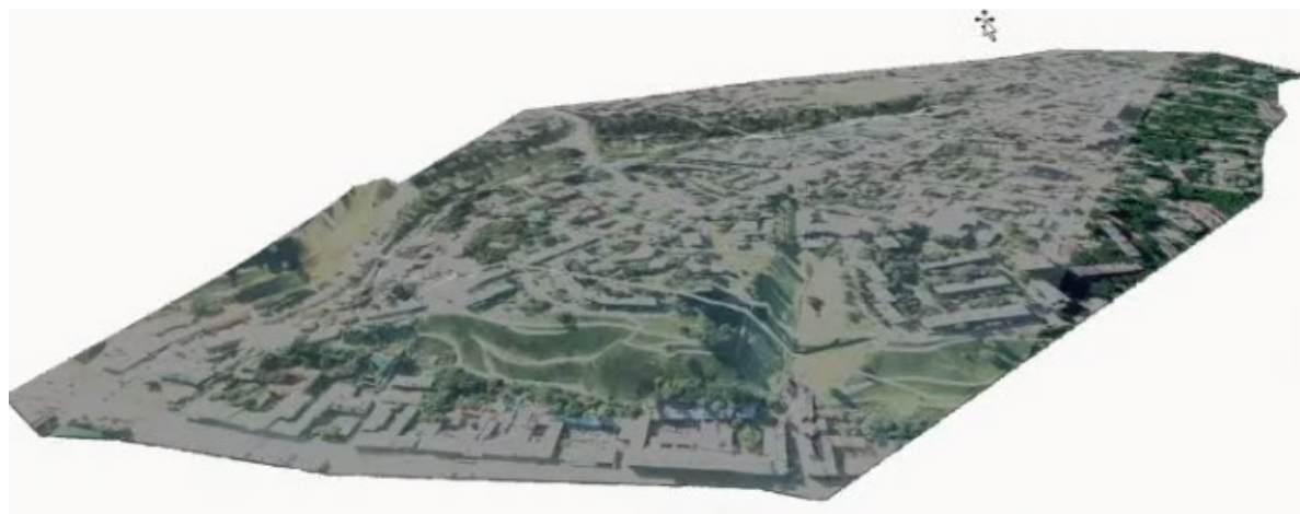
Рис. 2. Цифровая модель рельефа, полученная текстурированием ортофотоплана
