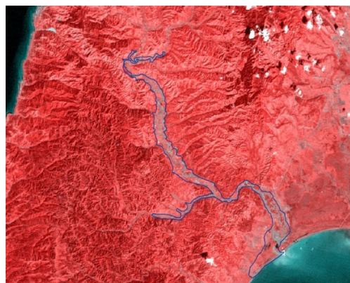
Рис. 5. Выделение зоны затопления на р. Лютоге после прохождения тайфуна «Филлис» по архивным снимкам Landsat 3
