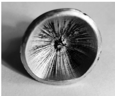
Рис. 5. Гофры на поверхности алюминиевой облицовки при ее импульсном нагружении высокоинтенсивным осесимметричным магнитным полем
