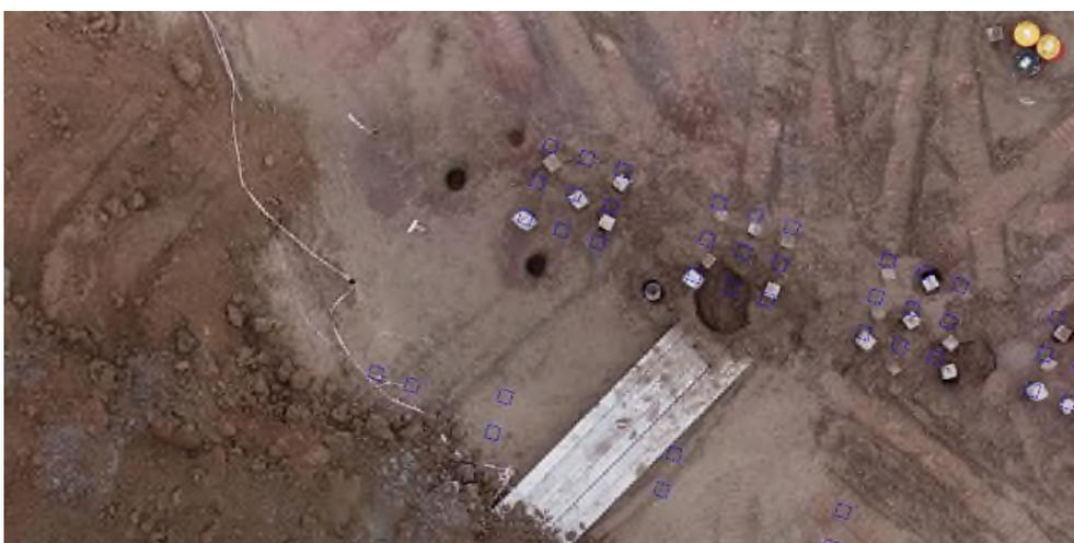
Рис. 10. Контроль соответствия размещения элементов свайного фундамента проектным решениям
