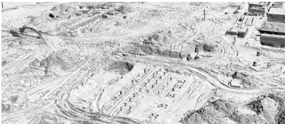
Рис. 3. Полигональная модель объекта строительства, построенная по результатам съемки с использованием БПЛА
