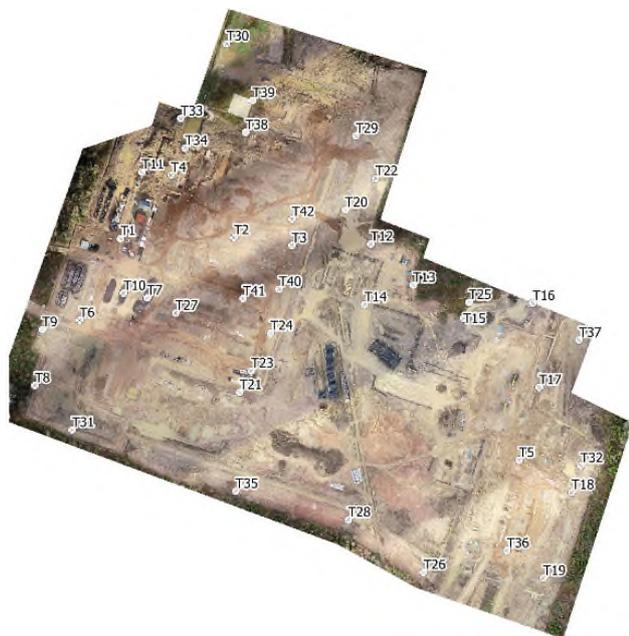
Рис. 7. Схема опорных знаков на территории площадки строительства
