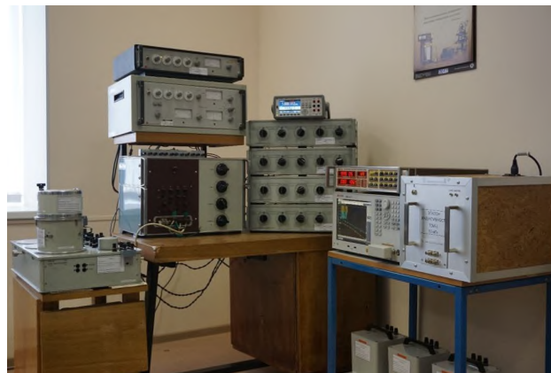
Рис. 2. Государственный первичный эталон для определения единицы индуктивности
