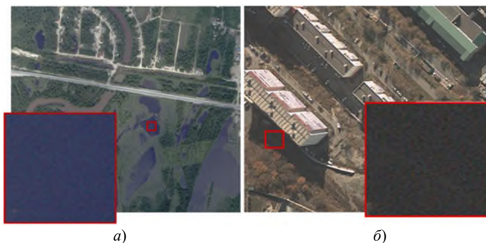
Рис. 13. Пример случайного шума на аэрофотоснимке, заметного при сильном увеличении: а) на участке водной поверхности; б) в области тени от многоэтажного дома
