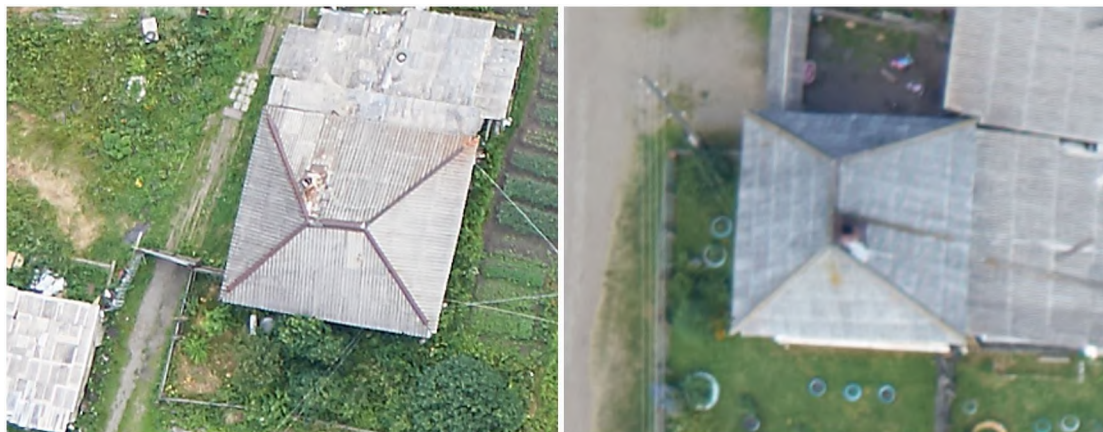
Рис. 1. Пример фрагментов аэрофотоснимков различной резкости (четкости): резкость (четкость) правого снимка заметно ниже, чем левого снимка
