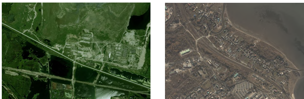
Рис. 15. Пример нарушения правильности цветопередачи – перекос цвета снимка в область одного тона
