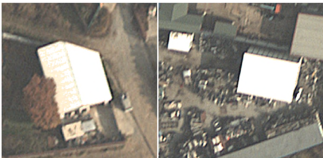
Рис. 7. Пример областей засветки на аэроснимках
