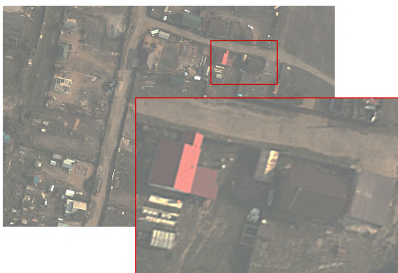
Рис. 5. Пример влияния атмосферной дымки на дешифровочное качество аэроснимка
