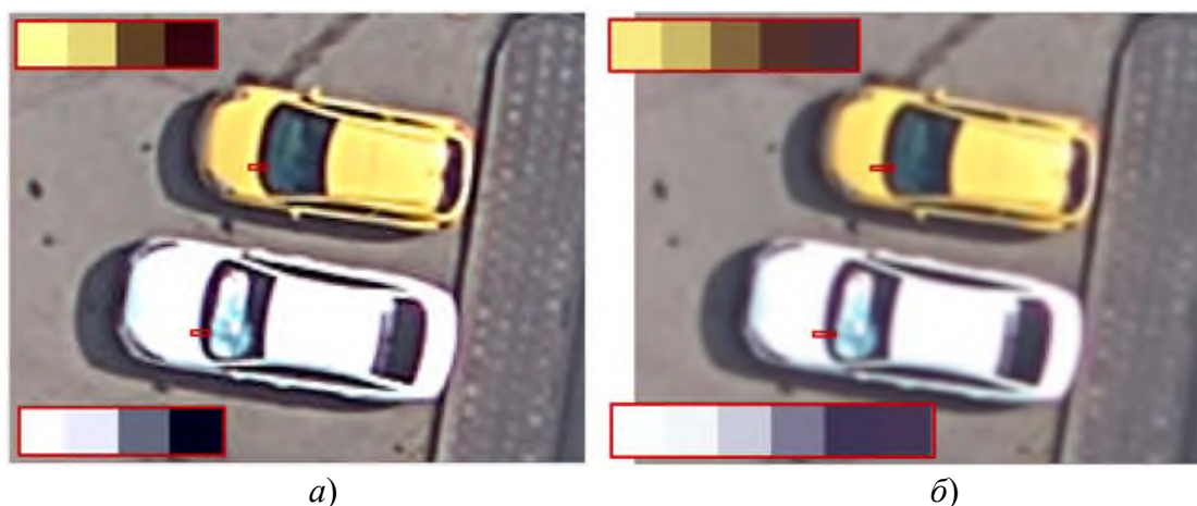
Рис. 2. Пример изображения резкого края и пограничного перехода: а) на резком снимке; б) на нерезком снимке
