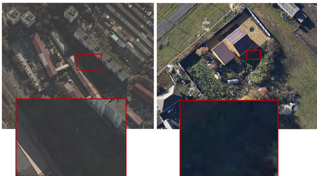
Рис. 8. Пример глубоких теней на аэроснимках, препятствующих дешифрированию попавших в них объектов
