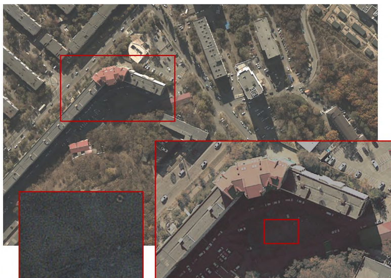
Рис. 12. Пример снижения информационного и дешифровочного качества аэроснимка из-за глубоких теней и высокого уровня случайного шума
