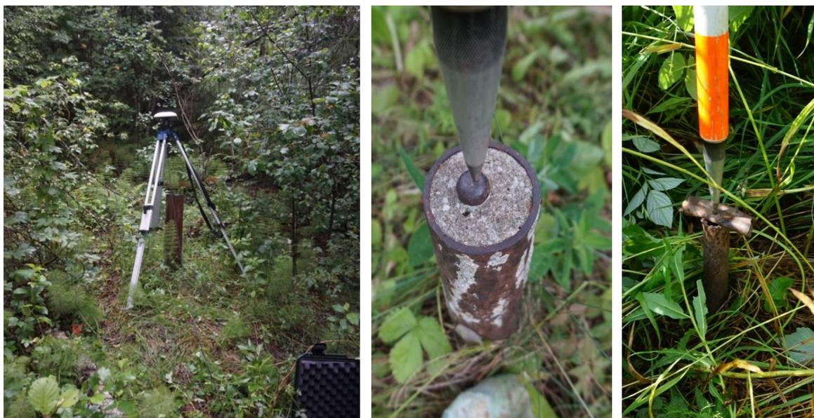
Рис. 5. Пункты, расположенные на вертикальных сторожках, трубах и рельсах
