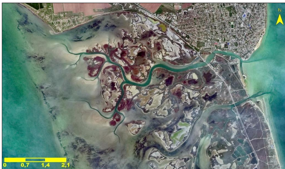
Рис. 7. Система протоков, по которым осуществляется водообмен залива Сиваш с Азовским морем
