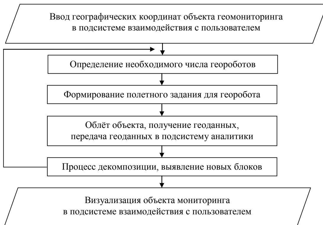
Рис. 1. Обобщенная схема мониторинга техногенных объектов с применением робототехники на основе теории мультиагентных систем
