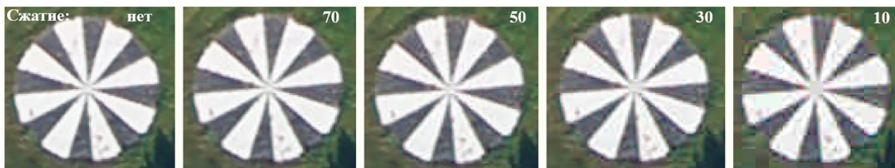
Рис. 9. Влияние коэффициента сжатия на дешифровочное качество изображения (при неизменной фактической разрешающей способности на изображении появляются артефакты сжатия)
