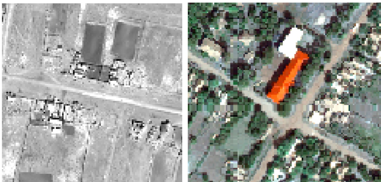
Рис. 2. Фрагменты ортофотопланов масштаба 1 : 25 000 некондиционного дешифровочного качества в результате сжатия, передаваемые для хранения в ФФПД, размер пикселя на местности – 2.1 м
