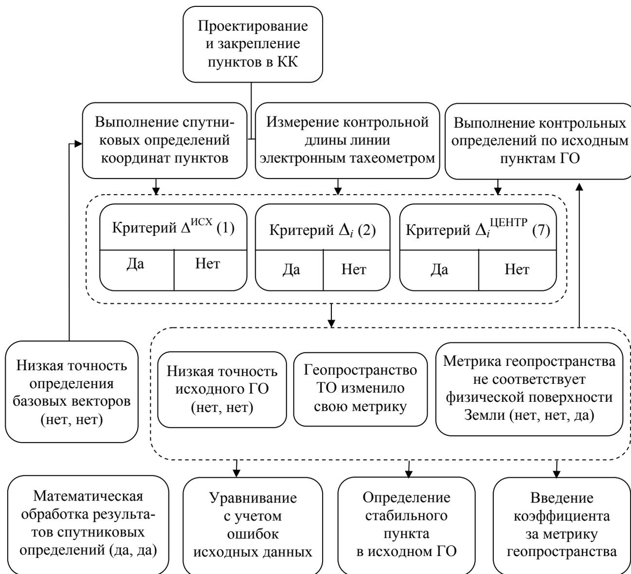
Рис. 3. Технологическая схема построения и математической обработки второй ступени геодезического обоснования в кадастровом квартале
