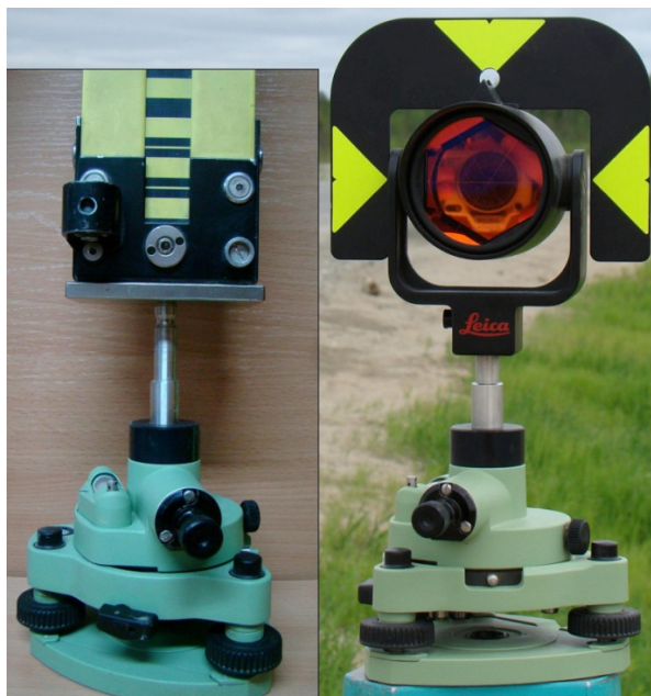
Рис. 1. Схема постановки нивелирной рейки на адаптер
