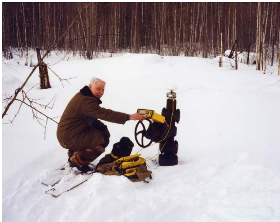
Ю.В. Сурнин с приемником 4000SE на привязке скважины на Салымском нефтегазовом месторождении (март 1999 г.)
