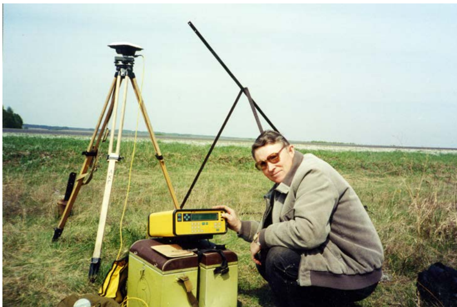
К.М. Антонович во время сеанса наблюдений с приемником 4000SST на пункте Коченево. Металлическая пирамида удалена на время сеанса (май 1997 г.)
