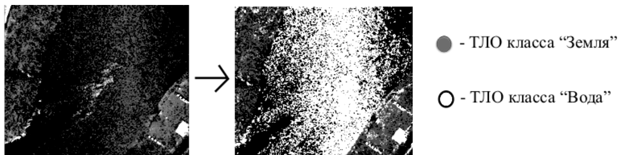
Массив точек после автоматической классификации → ТЛЮ после интерактивной классификации
