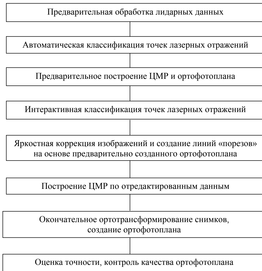
Рис. 1. Методика ортотрансформирования снимков по данным воздушного лазерного сканирования в ПП TerraSolid
