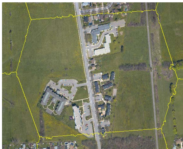
Рис. 3. Пример отредактированных линий «порезов» изображений
